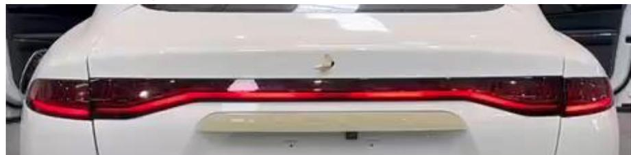
貫穿式尾燈可以通過閃爍、變色等燈光效果，向其他車輛和行人傳遞資訊，提升行車安全性。例如，可以使用閃爍的燈光效果來提醒後方車輛進行緊急制動；可以使用變色的燈光效果來表示車輛的轉向意圖，根據 Global Market Insights 的報告，全球貫穿式尾燈市場規模預計將從 2024 年的 59 億美元增長到 2032 年的 86 億美元，複合年增長率為 5%。其中，豪華車和高性能車是貫穿式尾燈市場的主要驅動力。
